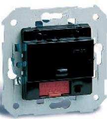
ИК-регуляторы 75355-39 позволяют регулировать нагрузку, включать или выключать ее с помощью пульта дистанционного управления 75350-69 или локально с помощью кнопки. Также можно подключить кнопочные выключатели в качестве вспомогательных механизмов. Возможна установка таймера выключения от 0 до 999 минут (программируется с пульта).
