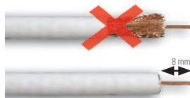
Для подключения модульных розеток R-TV+SAT необходимо зачистить на кабеле только центральную жилу до 8 мм.
