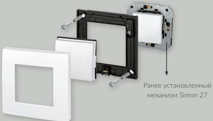
Основание рамки Simon Scudo крепится к стене с помощью дюбелей и винтов, доступ к которым закрывается при монтаже устройства.
