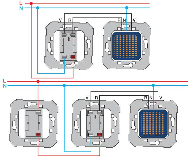
Для отключения индикатора рекомендуется использовать дополнительный выключатель.
