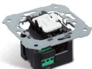
Кнопочные регуляторы могут работать совместно с обычными кнопочными выключателями. Включение и выключение цепи питания производится коротким нажатием на клавишу. Регулировка напряжения производится продолжительным нажатием.
