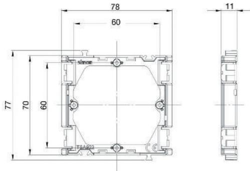
АДАПТЕР ДЛЯ МОНТАЖА S-МОДУЛЕЙ И DIN-ЭЛЕМЕНТОВ
