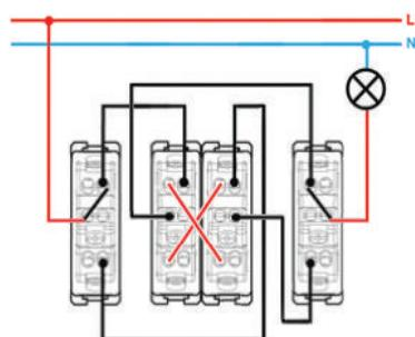
Для перекрестной схемы подключения одной нагрузки или управления одной нагрузкой с 3-х мест необходим перекрестный выключатель 1591251 и два переключателя 1591201
