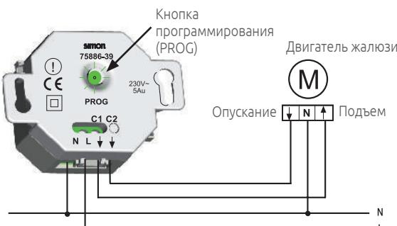
Радиочастотный приемник управления жалюзи 75886-39 используется в сочетании с передатчиком 75888-39.
