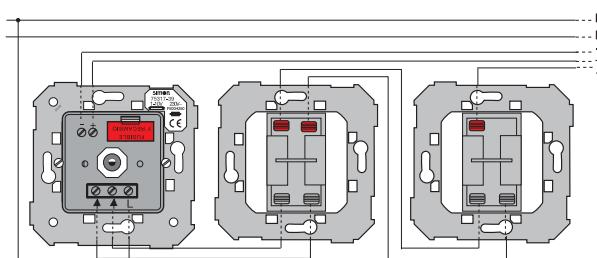
Светорегулятор, перекрестный выключатель и переключатель (проходной)
