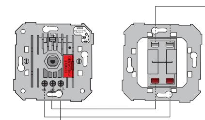
Светорегулятор, перекрестный выключатель и переключатель (проходной)
