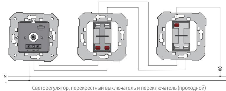
Светорегулятор, перекрестный выключатель и переключатель (проходной)
