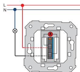
Подключение без реле с максимальной нагрузкой
