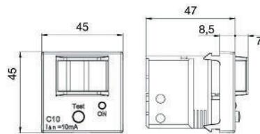
МОДУЛЬ С КРЫШКОЙ ДЛЯ УСТРОЙСТВ ЗАЩИТЫ И АВТОМАТИКИ
