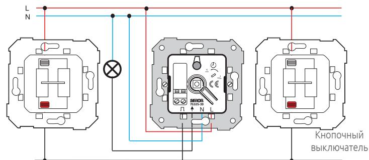
Таймерный выключатель и дополнительные выключатели
