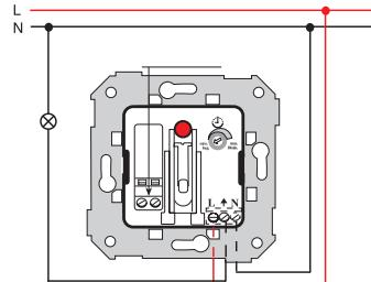
Подключение без реле с максимальной нагрузкой
