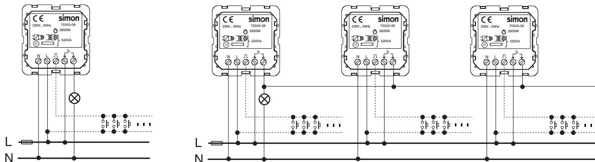
**ВАЖНО.** Не предназначен для установки кнопочных выключателей с подсветкой
