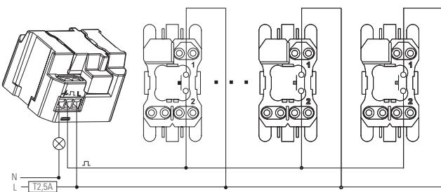
Установка в монтажную коробку с кнопочными выключателями Simon 27 с широкой клавишей.
