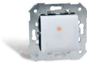
Кнопочный таймерный выключатель предназначен для установки в общественных местах и местах, где важно уменьшить расход электроэнергии за счет неконтролируемого времени работы нагрузки. Диапазон установки таймера от 4 сек. до 10 мин.
