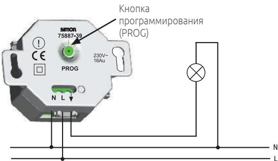
Радиочастотный приемник-выключатель 75887-39 используется в комбинации с передатчиком 75888-39.
