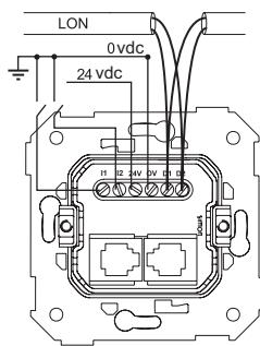
Подключение с панелью Slide Control
