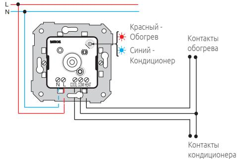
Примечание. Контакты нагрузок независимы от устройства. Для подключения используется перемычка или отдельная линия цепи.
