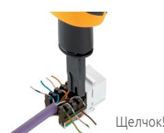
3/ При этом инструмент обрезает оболочку кабеля
