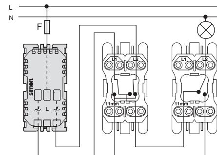
Светорегулятор, перекрестный выключатель и переключатель (проходной)
