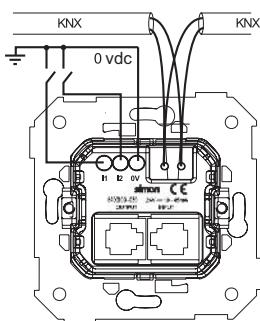
Подключение с панелью Slide Control
